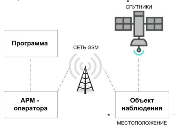
Рис. 1. Мнемосхема принципа функционирования навигационной системы
