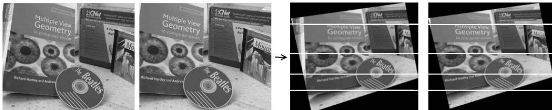
Рис. 2 – Входная стереопара и результат процесса выпрямления этой стереопары.
