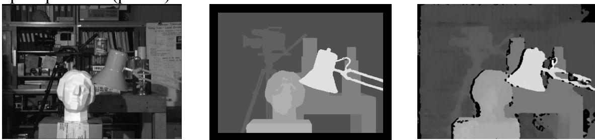
Рис. 3. Левый кадр исходной стереопары (слева), реальная карта глубины (по центру) и полученная с помощью алгоритма SGBM (справа) [4].
